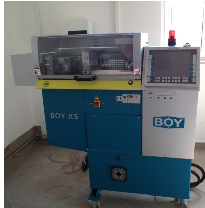
Laboratoryjna wtryskarka wysokociśnieniowa BOY XS
