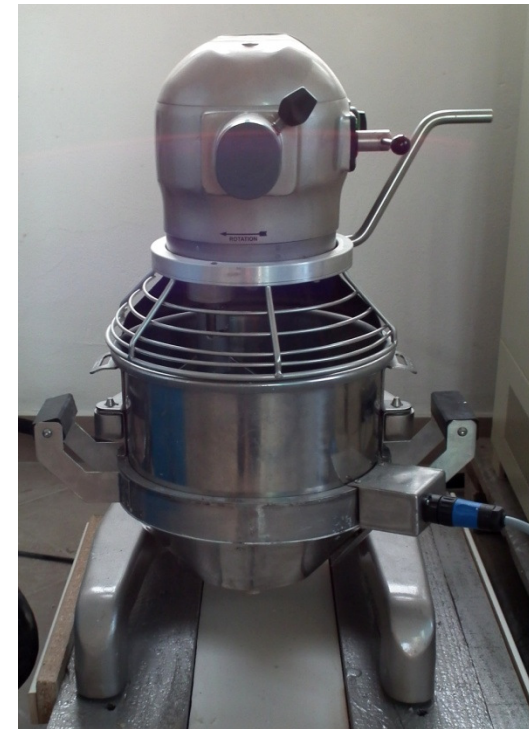
Urządzenie do urabiania masy ceramicznej z termoplastyfikatorami GC-MIX-12/13
