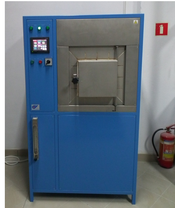
Piec do odprowadzania lepiszcza z wewnętrzną recyrkulacją FCF 14/160M
