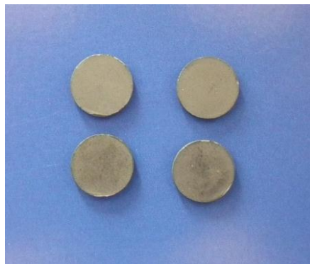
Pastyłki z perowskitu LNC o wymiarach \varnothing 9,7 \times 1,3 mm po wypaleniu
