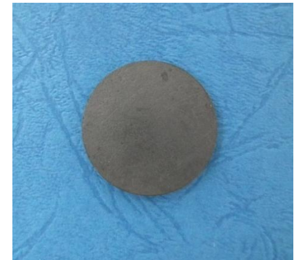
Cienka gęsta membrana LNC na porowatym podłożu
