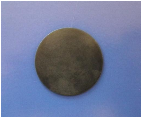
Gęsta cienka membrana z perowskitu LNC po wypaleniu i oszlifowaniu
